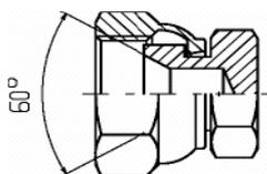
**Gerade Einschraubverschraubung mit vormontierter Mutter**
